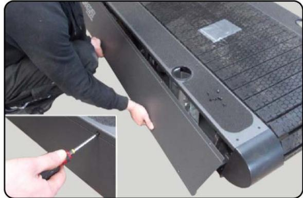
2. Nach dem Entfernen der seitlichen Abdeckungen können die **oberen (1)** und **unteren Schrauben (2)**, die jede Endkappe halten, entfernt werden, um Zugang zu den Querwellenlagern zu erhalten.
