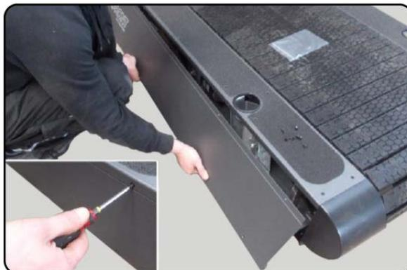
2. Wenn die Abdeckungen entfernt sind, haben Sie Zugang zu den 3 Muttern, mit denen die **Handlaufhalterungen (1)** auf jeder Seite des Geräts befestigt sind. Auf der rechten Seite (Schaltschrankseite) befinden sich elektrische Anschlüsse (2/3), die vor dem Abnehmen des Handlaufs getrennt werden müssen.
