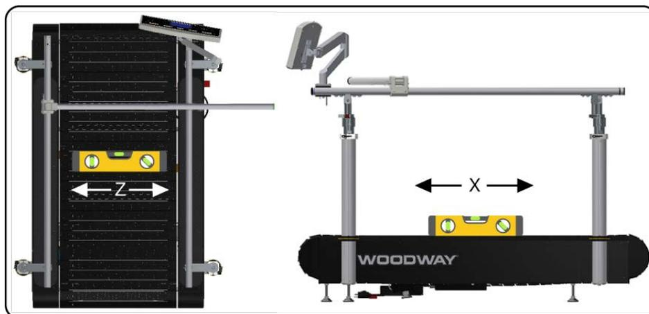
6. Verwenden Sie zur Überprüfung der X-Achse eine Wasserwaage, die Sie auf die obere Seitenverkleidung des Gestells legen und zur Überprüfung der Z-Achse eine Wasserwaage, die Sie gleichmäßig auf eine der Lamellen legen.
