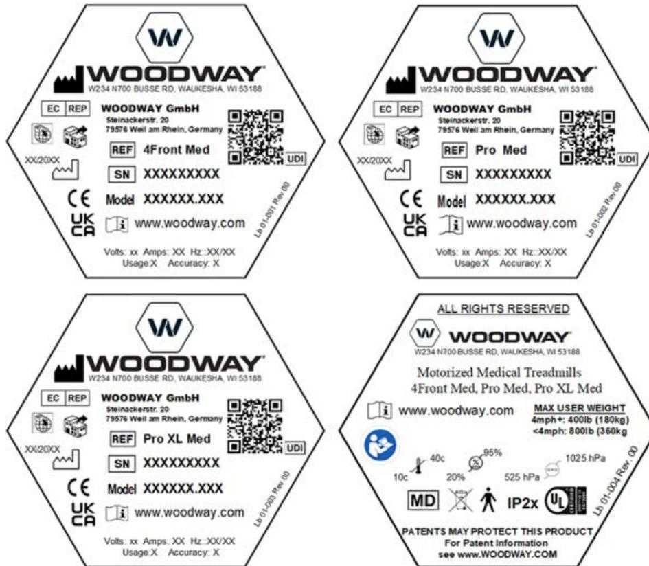
Jedes WOODWAY-Laufband erhält bei der Produktion eine Seriennummer. Je nach Baujahr Ihres Modells hat sie einen alphanumerischen Code mit 7-8 Zeichen oder einen numerischen Code mit 9 Ziffern. Die Seriennummer finden Sie auf dem Typenschild, das auf der Rückseite des Displays oder auf der linken Vorderseite des Laufbandrahmens angebracht ist.
