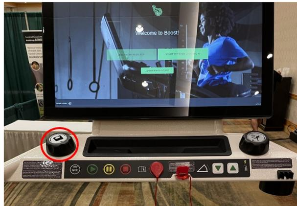
3. Die rote Stoptaste beendet das Training, lässt die Luft aus dem Airbag und stoppt das Laufband.
