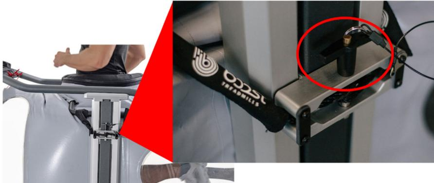
3. Lassen Sie den Dichtungsrahmen und Airbag auf den Boden fallen und schieben Sie alle Stoffe, die den Ausstieg eines Benutzers aus der Maschine behindern könnten, manuell aus dem Weg.
