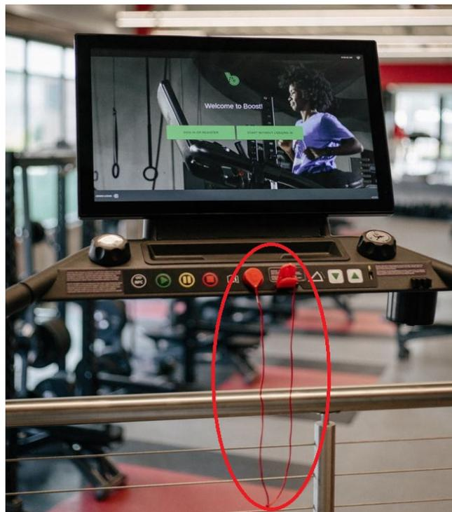
Dazu gehört das Abschalten des Laufband- und des Steigungsmotors, des Gebläses und der Liftermotoren.
