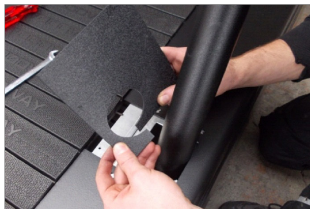
Abb. 30 Montage Mercury/Path, Abdeckplatten
