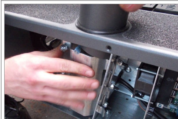
Abb. 11 Montage 4Front, Aufnahme Rohr
