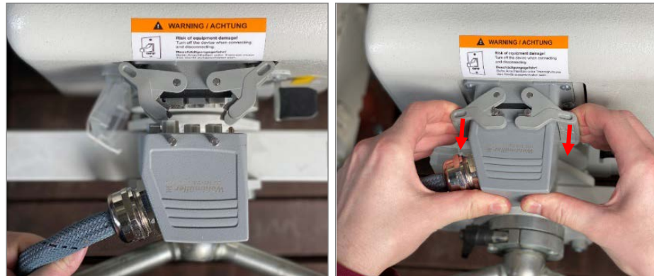
Abb. 11 Steuergerätestecker an LokoHelp® anschließen und verriegeln
