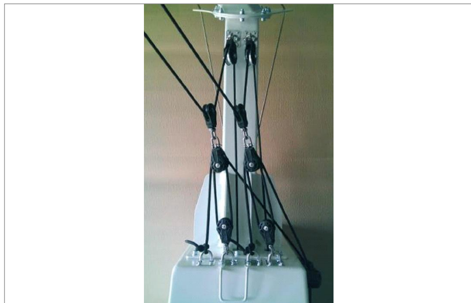
Abb. 23 ELVETA, doppelseitige Seillängenverstellung
