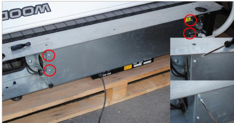
Abb. 6 Abschirmblech der Elektronik entfernen
