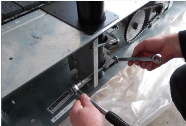
Abb. 38 Montage Pro/ProXL, Geländerbefestigung 2
