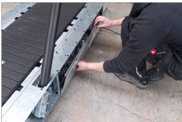
Abb. 28 Montage Mercury/Path, Elektronikabdeckblech
