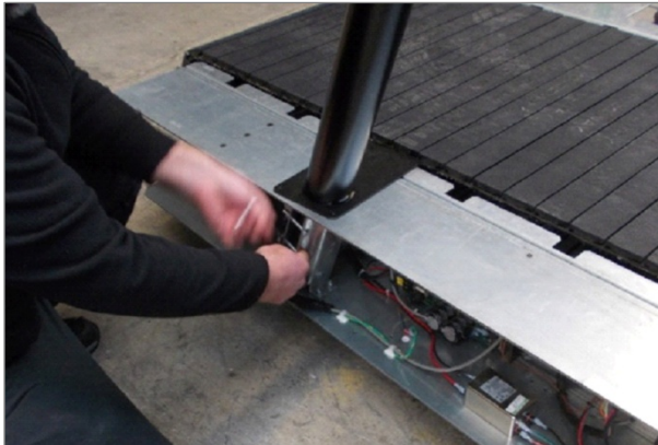
Abb. 31 Montage Pro/ProXL, Geländer einstecken
