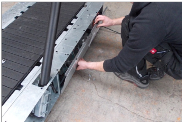
Abb. 19 Montage Mercury/Path, Elektronikabdeckblech
