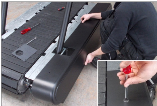
Abb. 29 Montage Mercury/Path, Verkleidung
