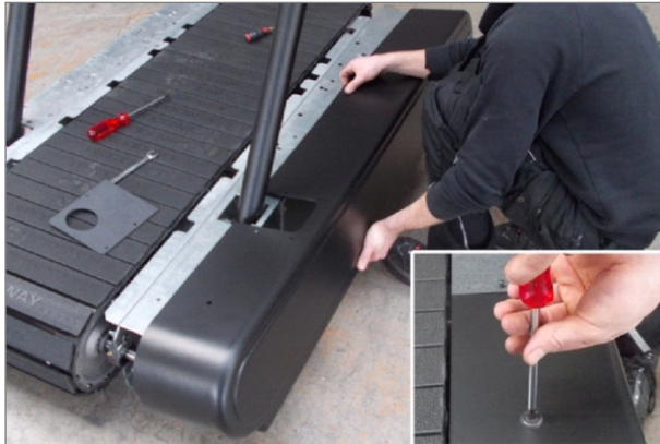
Abb. 18 Montage Mercury/Path, Verkleidung
