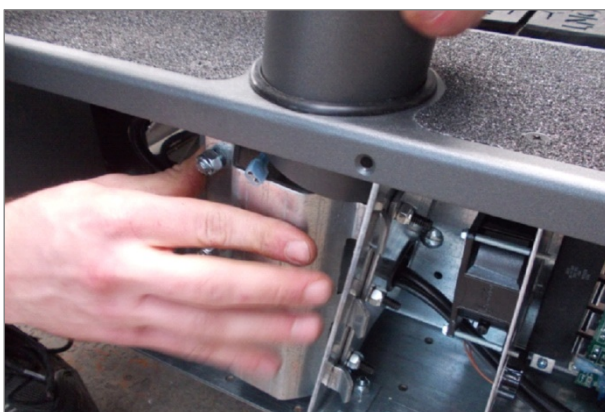
Abb. 11 Montage 4Front, Aufnahme Rohr
