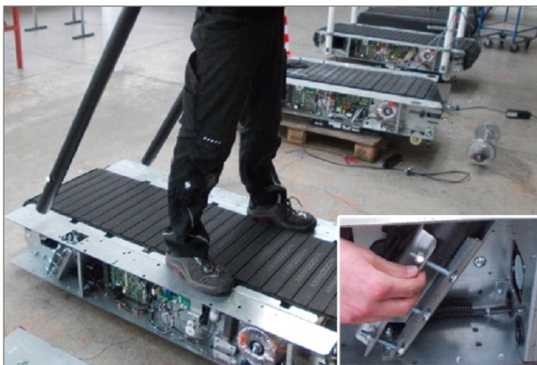
Abb. 22 Montage Mercury/Path, Rohr einstecken
