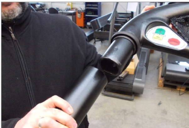
Abb. 32 Montage Pro/ProXL, Geländer verbinden
