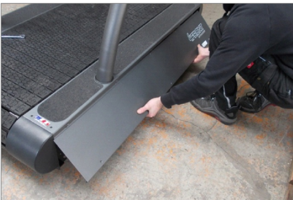
Abb. 17 Montage 4Front, Seitenblende
