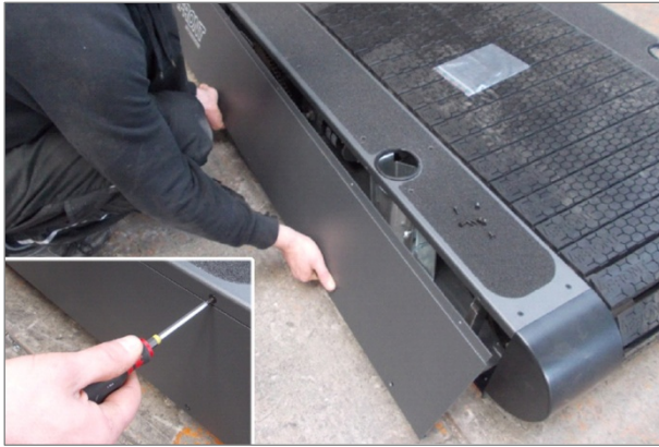
Abb. 9 Montage 4Front, Seitenblende
