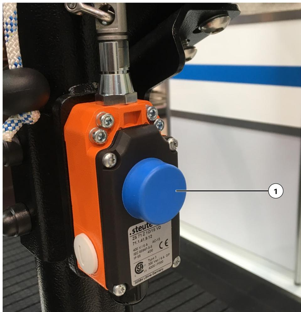
Abb. 12 Zugschalter mit Entriegelungsknopf
