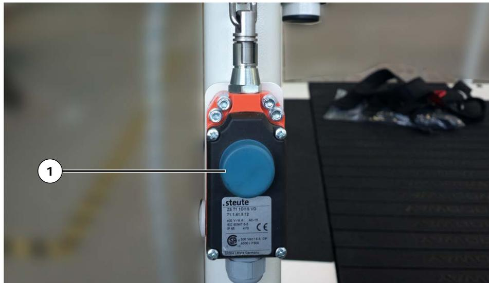
Abb. 11 Zugschalter mit Entriegelungsknopf
