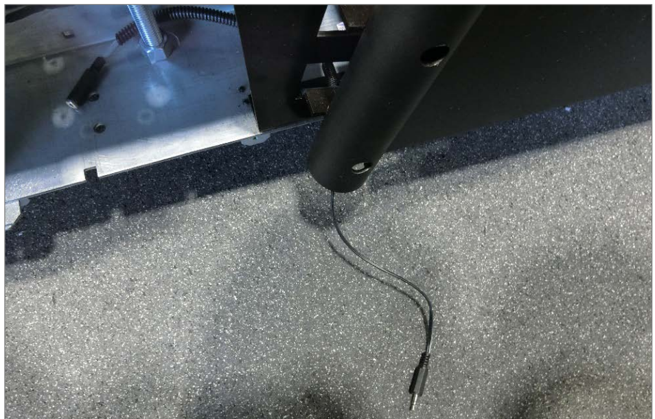
Abb. 19 Montageschritt, Geländer aufstecken - Kabel (CURVE TRAINER)
